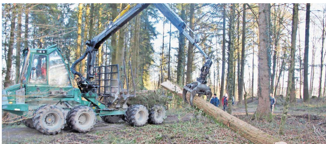
René Fischer zeigt den Einsatz mit dem Forwarder, um geschlagenes Holz aus dem Wald abzuführen.
